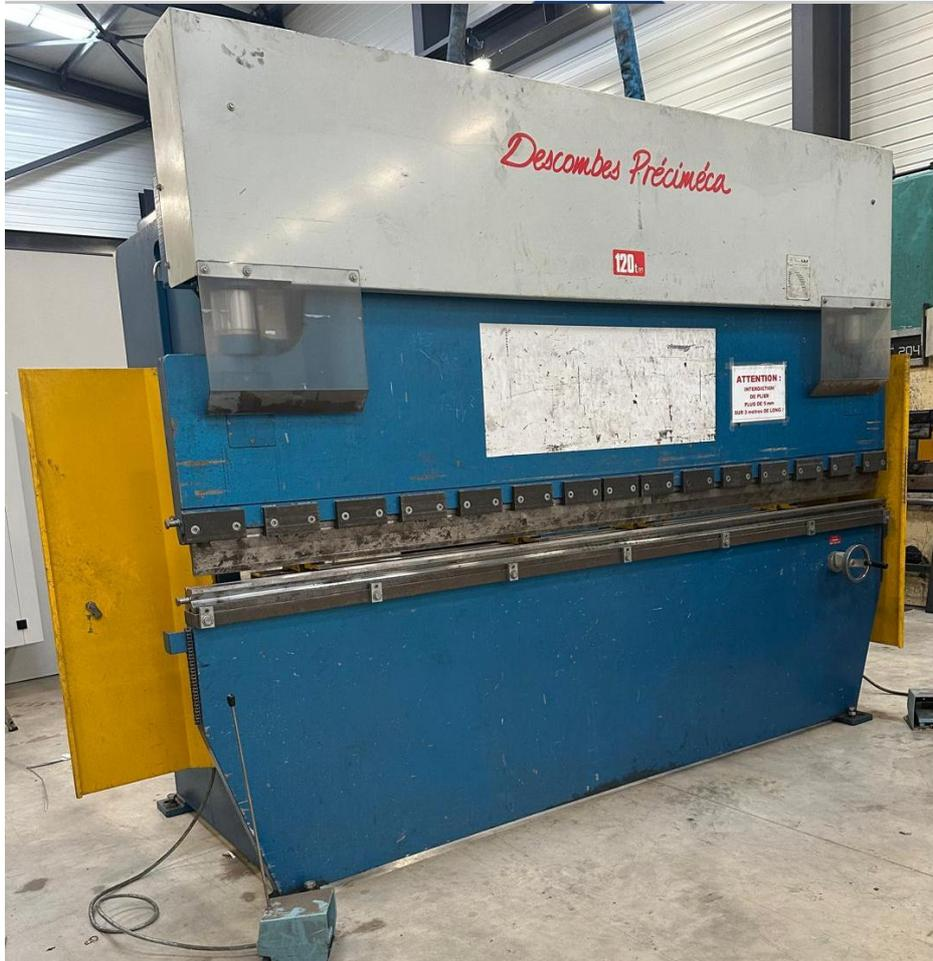
PP hydraulique DESCOMBES PRECIMECA PBM 3120
