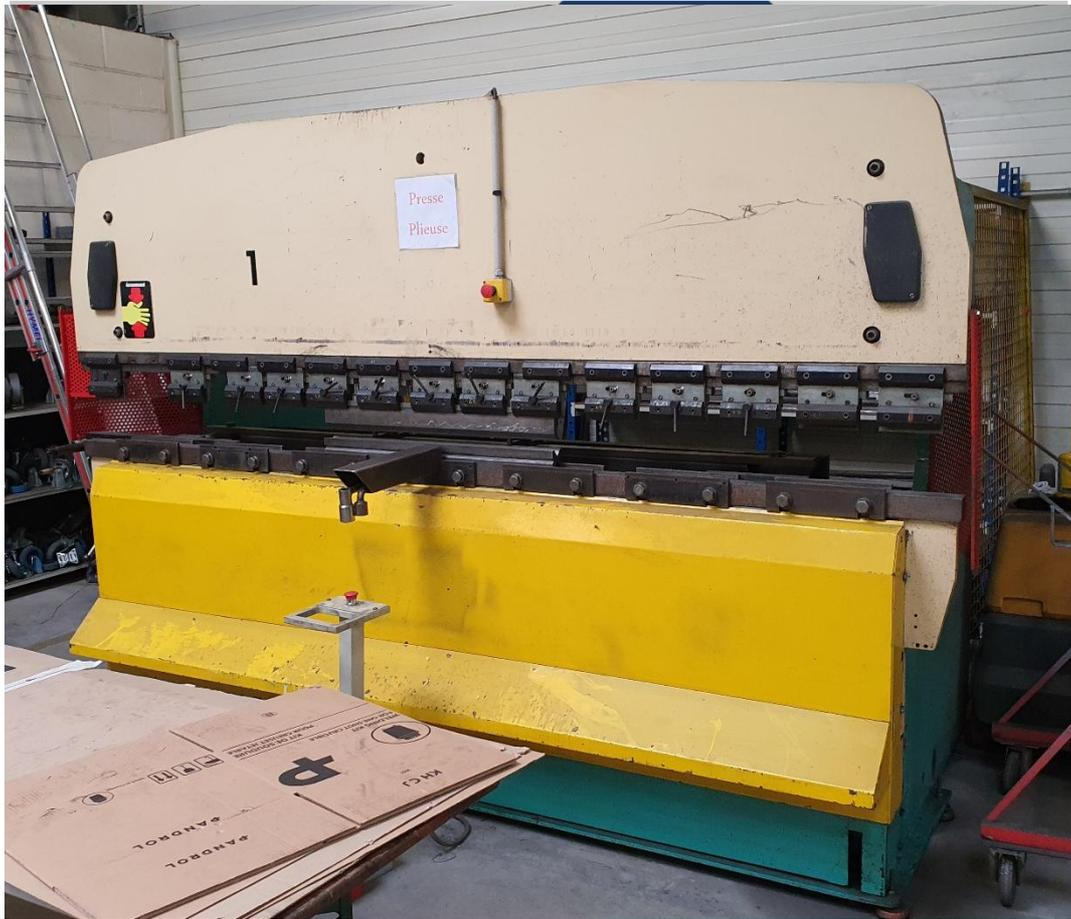
Presse plieuse hydraulique PROMECAM RG 65-30
