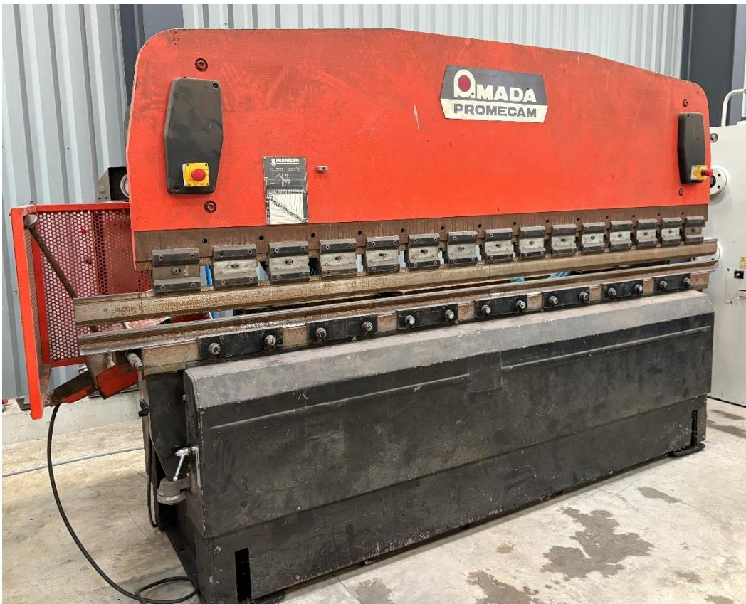
Presse plieuse hydraulique PROMECAM RG 103
