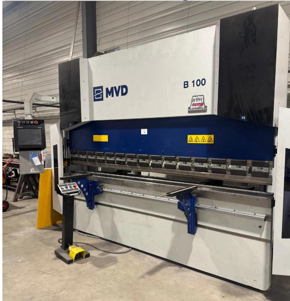
Presse plieuse hydraulique MVD Ibend B 100-3100
