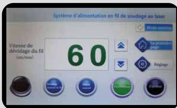
Réglage système d'apport de fil
