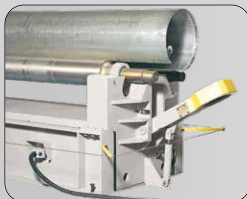
Ouverture hydraulique du palier
