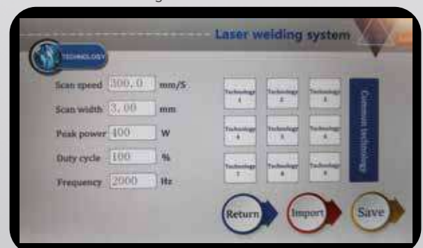
Réglage des paramètres de soudure et sauvegarde dans base de données
