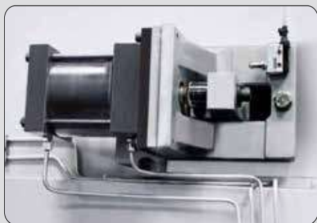
Tension hydraulique et automatique de la lame
