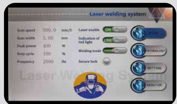
Réglage des paramètres de soudure et sauvegarde dans base de données
