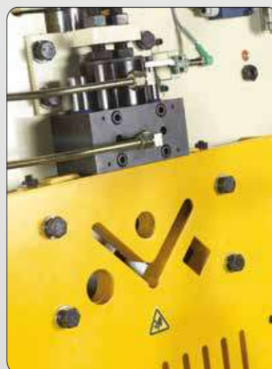
Serre-flan hydraulique en option sur la BENDICROP 85 SD
