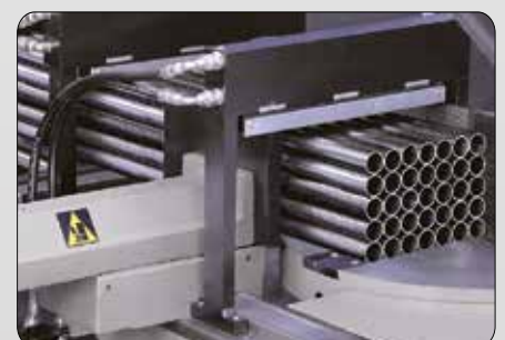
Étaux hydrauliques coupe en paquets
