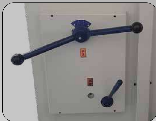
Réglage manuel du jeu entre les lames
