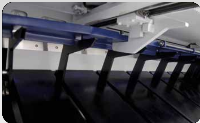
Soutien tôle pneumatique sans billes
