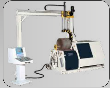
Système de déchargement automatique
