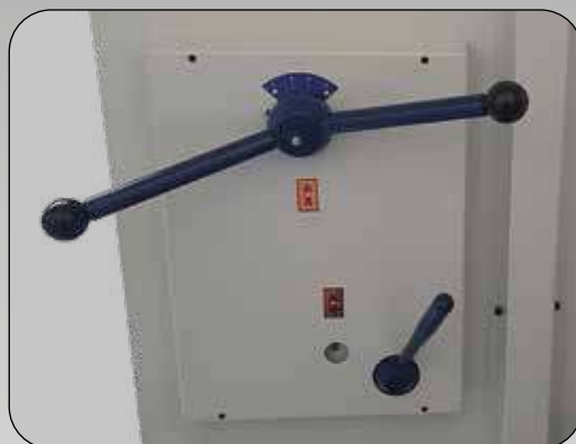
Réglage manuel du jeu entre les lames
