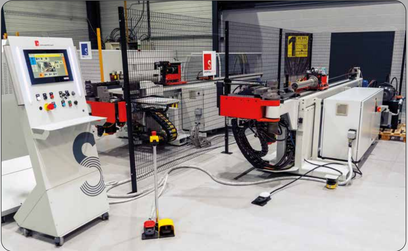
Cintrage par enroulement
