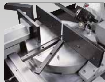
Plateau tournant sur roulement à billes
