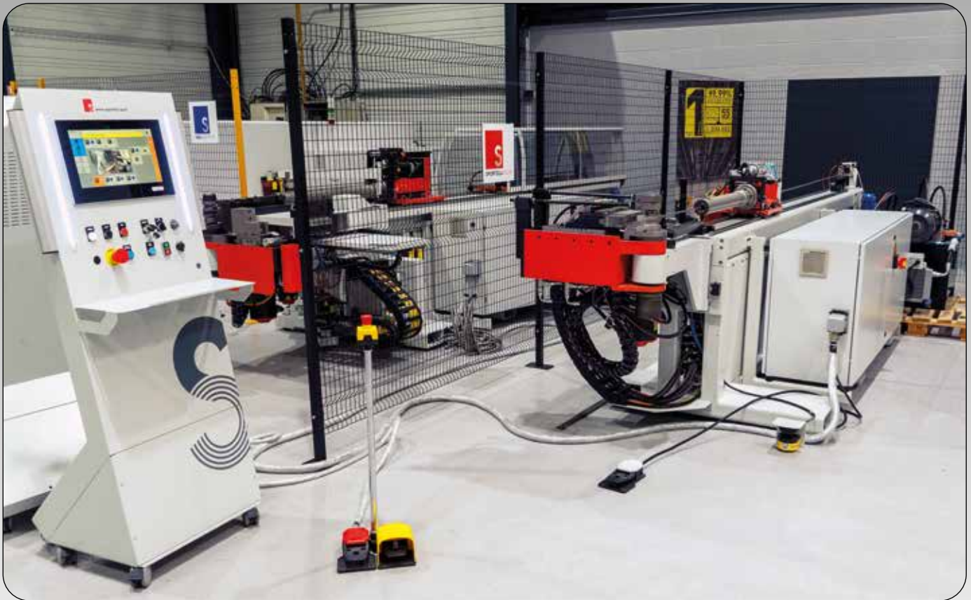
Cintrage par enroulement
