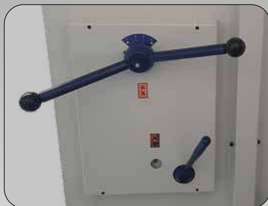
Réglage manuel du jeu entre les lames
