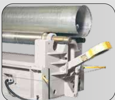
Entraînement par moteur hydraulique
