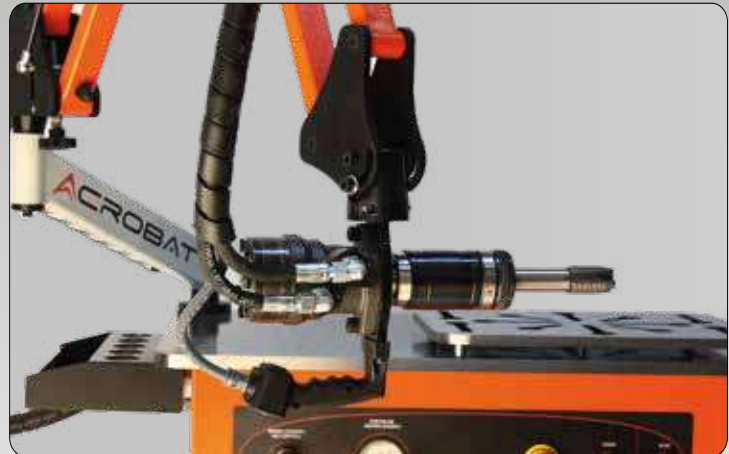
Bras de taraudage HUK moteur hydraulique
